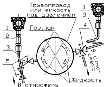
Рисунок 15 – Рекомендации по монтажу датчиков (кроме моделей XXX4, XXX5 и XXX6).
