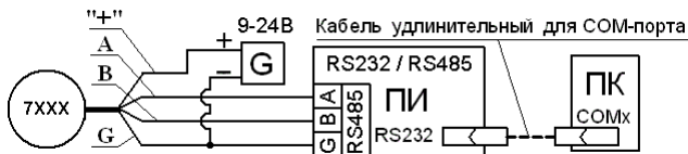
Рисунок Б.6 Выходной сигнал RS485
