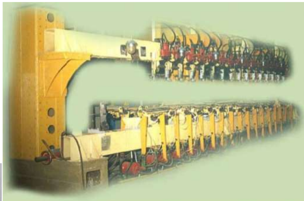
Стапель сборки-склейки лопасти вертолета Ми-26
