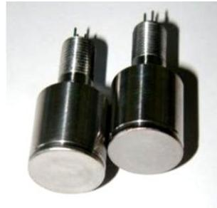
Преобразователи 223М, 224М разработаны на основе конечно-элементного математического моделирования, используются в ультразвуковых время-импульсных и корреляционных расходомерах газа с условным проходом от 25 до 1200 мм. для магистральных трубопроводов, факелов, в том числе для измерения попутного нефтяного газа. Могут работать в гармоническом и импульсном режиме. Применяются в счетчиках расхода газа «Dymetic-1223-К», «Dymetic-1223-Т» СГП-1 и других.
