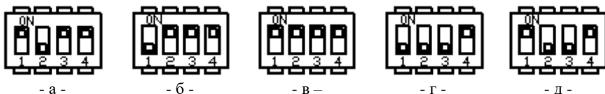
Рисунок 4 - Положение переключателей при проведении операций настройки и калибровки датчика моделей 8XX1÷8XX7.
