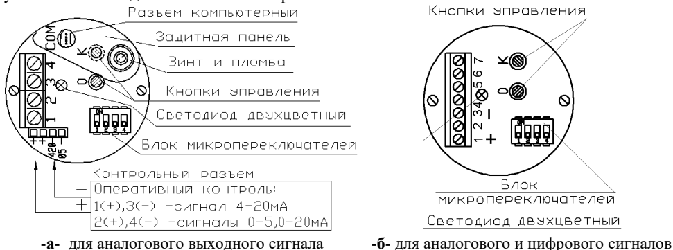
Рисунок 3 – Схемы монтажных плат с элементами регулировок датчиков моделей 8XX1÷8XX7
