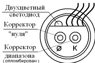
Рисунок 13 – Схемы верхней платы и элементов регулировок датчиков моделей 7XXX и 8XX8
