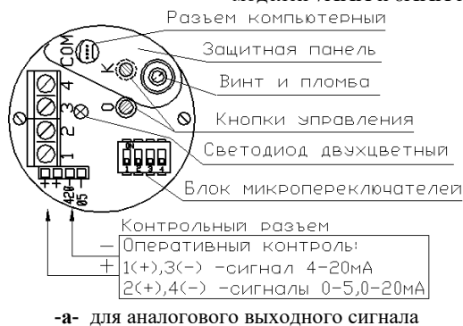
Рисунок 12 – Схемы монтажной платы и элементов регулировок датчиков моделей 8XXX (кроме моделей 8XX8)
