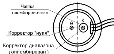
Рисунок 13 – Схемы верхней платы и элементов регулировок датчиков моделей 7XXX и 8XX8
