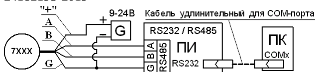
Рисунок Б.6 Выходной сигнал RS485
