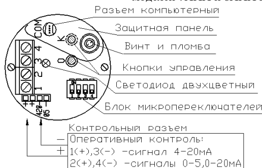
Рисунок 11 – Функциональная схема электронного блока датчиков моделей 7XXX и 8XXX кроме моделей 8XX8.
